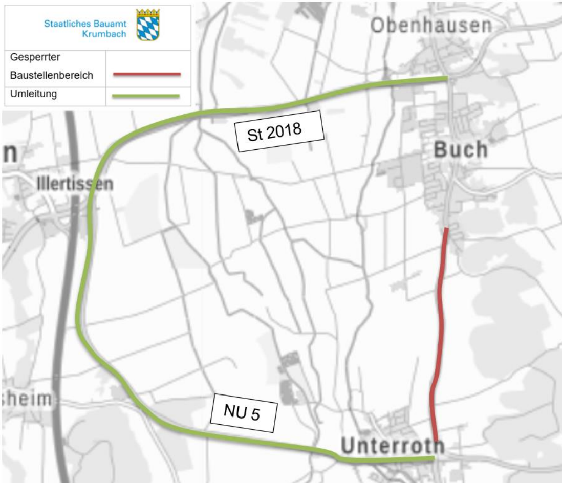
Abbildung 1 Umleitungsübersicht der Baumaßnahme St 2020 Buch - Unterroth
